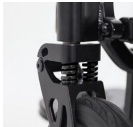
Fourche avant à double suspensions
