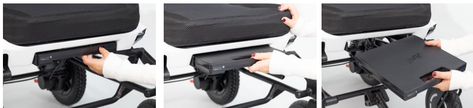
Illustration 2 : Retrait de la batterie — appuyez sur le bouton-poussoir tout en tirant la batterie hors de son logement.
