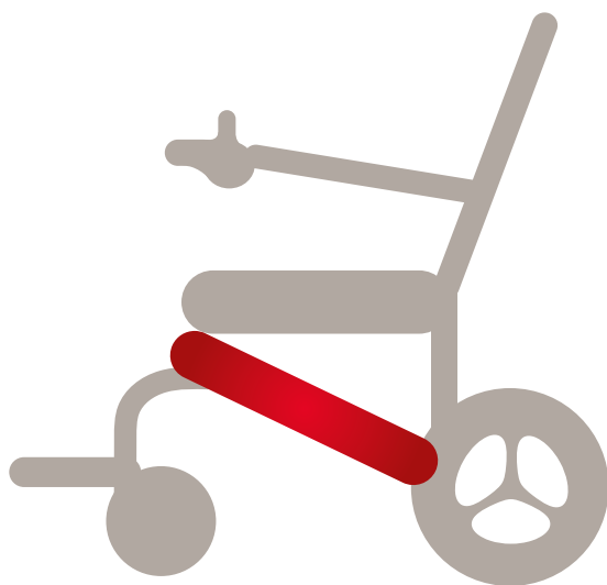
Emplacement de la batterie de l'ergoflix® LX
